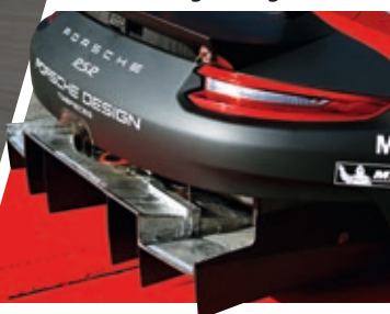
Der riesige Diffusor (unten l.) sorgt in Verbindung mit dem Heckflügel für einen gewaltigen Abtrieb. Damit ist hoher Kurvenspeed möglich
